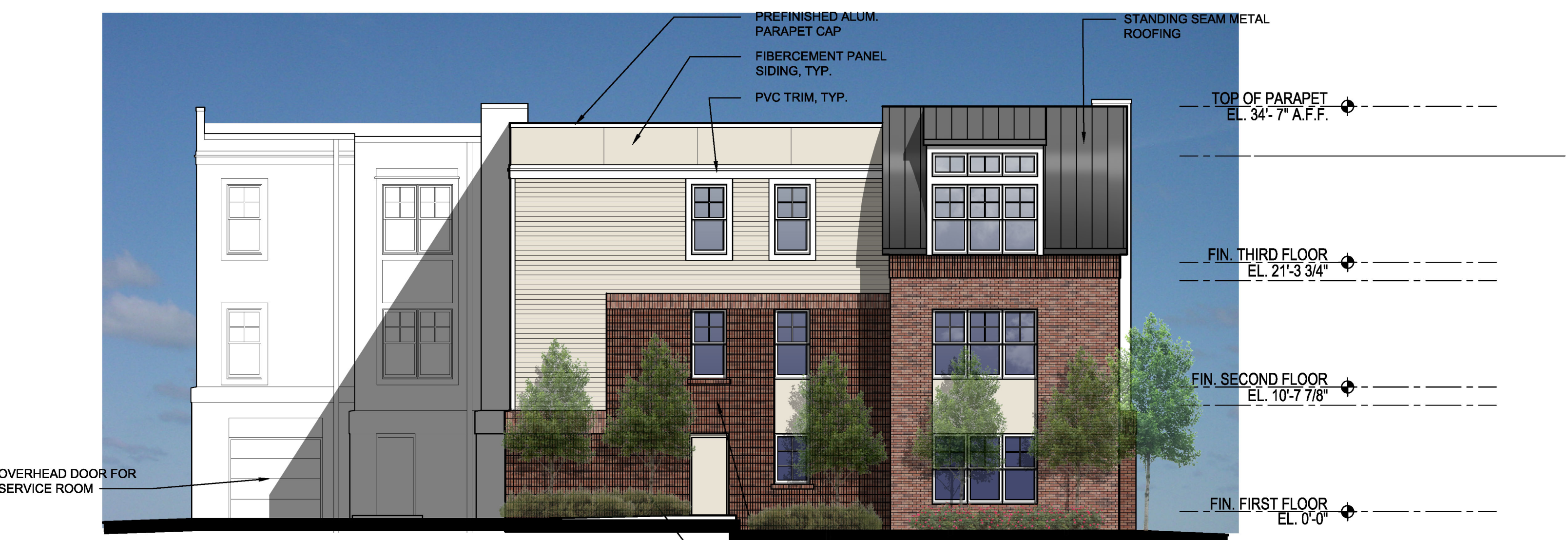
2 WEST ELEVATION A2.22 SCALE: 1/8" = 1'-0"
